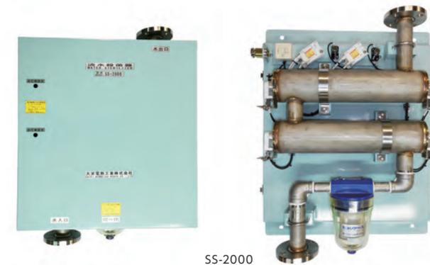
主に船舶の給水システムに組み込まれております。本装置は流水部中央に設置している紫外線殺菌器により、水中の細菌（大腸菌、チフス菌等）を殺菌する効果があります。また、ろ過器も付属しており、非常に衛生的な流水殺菌装置です。紫外線殺菌灯の交換目安は4000時間です。ろ過器のフィルターも交換可能で、メンテナンス性に優れます。交換用の紫外線殺菌灯、フィルターともに弊社にて販売しております。
