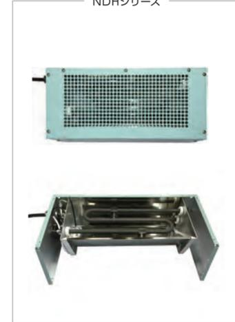
シーズヒーターを熱源にしているため、振動や衝撃に強い構造です。温度センサーを内蔵しており、希望の温度に設定することが可能です（30℃～110℃）。床置きタイプ、壁掛けタイプ、天井吊り下げタイプ等があり、設置箇所を問いません。電気式暖房機なので室内の空気を汚しません。船内の暖房用はもちろんのこと、衣類の乾燥用にもご使用いただけます。電気容量（目安）：1kW～4kW程度。大手造船所様へも長年に渡り多数の納入実績あり。船に合わせた塗装色でご提供いたします。使用電圧、ご希望容量、設置箇所等をお申し付けください。より最適な製品のご提案をさせていただきます。主に船舶向けで使用されていますが、船舶以外の設置も全く問題ございません。お気軽にご相談ください。お客様の仕様に合わせたオーダーメイドも喜んでご対応させていただきます。
